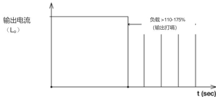
负载 < 110% 但 > 100% 时不建议长时间工作使用, 以免损坏 PSU。
