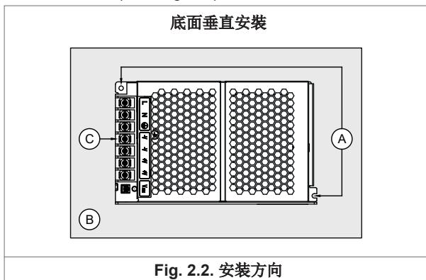
(A) 在把产品安装在固定表面时, 将螺丝锁入此固定孔。产品应该用长度至少 5mm 的 M3 螺丝锁入至少两个固定孔。
