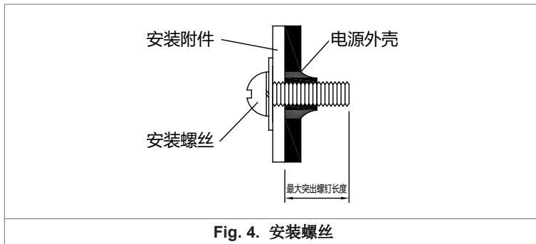
Fig. 4. 安装螺丝
